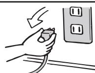
● 電源プラグを電源コンセントから抜くときは、必ず電源プラグを持って抜いてください。コードを引っ張るとコードが傷つき、火災・感電や断線の原因となることがあります。
